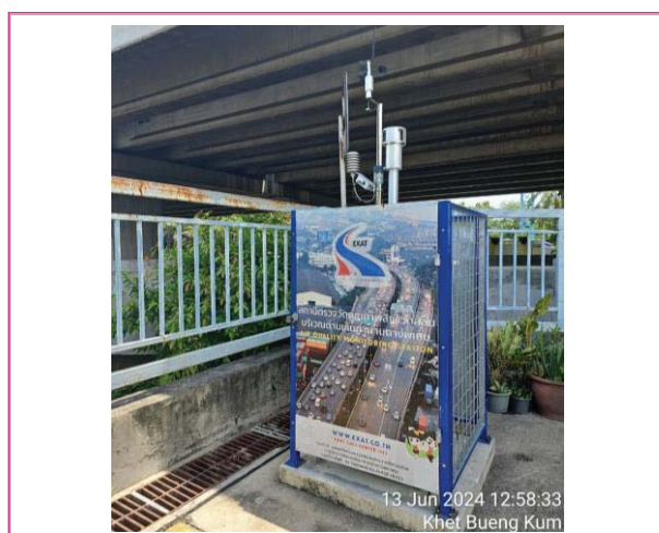
รูปที่ 3.2-18 ระบบเฝ้าระวังคุณภาพสิ่งแวดล้อม แบบ Online Real time (บริเวณด่านเก็บค่าผ่านทางพิเศษรามอินทรา)
